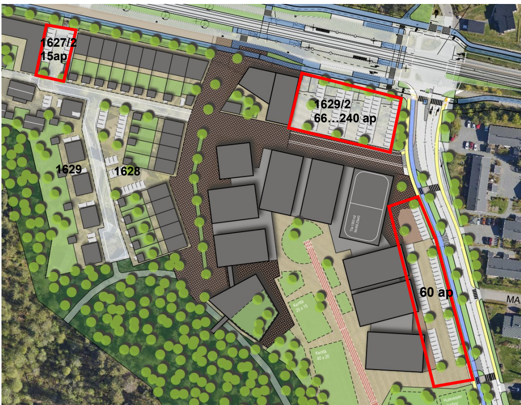
Kuva 22, Saattoliikenne ja 60 autopaikkaa sijoittuu koulun tontille. LPA-tontille 1629/2 sovitetaan pintapysäköintinä 66 ap tai useampitasoinen paikotuslaitos, jolloin autopaikkoja saadaan sopimaan 240 kpl. LPA-tontti 1627/2 on tarkoitettu viereisten Y-tontin sekä kaupunkipientalojen tarpeisiin. Korttelin 1628 autopaikoitus toteutetaan omilla tonteillaan, osittain keskitettynä ja osittain asuntokohtaisesti Kalliotien kautta. Korttelissa 1629 autopaikat sijoittuvat tonteille.
