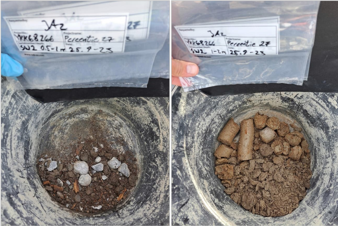
Kuvat 4 ja 5. Tutkimuspisteessä SW2 syvyydellä 0,5–1,0 m havaittiin pieniä määriä puuta sekä haitta-aineanalyysissä lyijyä. Syvyydellä 1,0 m maaperä oli savista.
