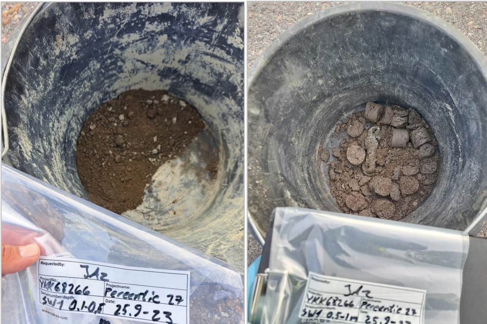
Kuvat 2 ja 3. Tutkimuspisteen SW1 pintakerroksessa todettiin pieniä pitoisuuksia öljyhiilivetyjä C10-C40. Syvyydellä 0,5 m maaperä oli savista.
